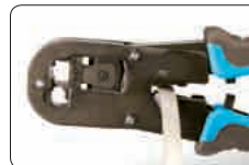
Corte de cables de red
