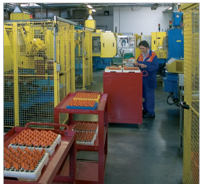
Cargando el control numérico multi-axial automático.
