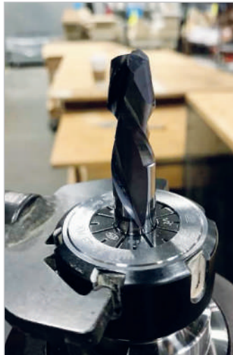
Fresa con revestimiento DLCS
