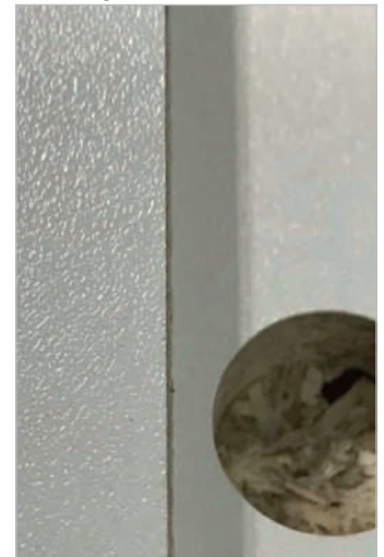
Corte de calidad después de 165 paneles.
